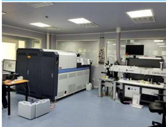
LA-MC-ICP-MS激光微区原位同位素分析
