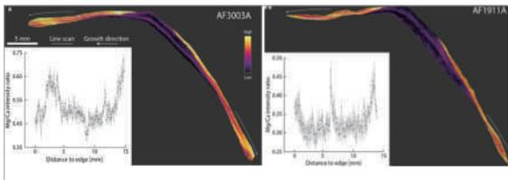
对*P. caerulea*贝壳进行LIBS元素成像分析，几乎所有样品的Mg/Ca值都呈条带状分布，与实际气候变化相吻合。
