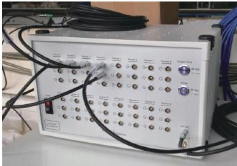
应用范围主要包括船模实验水池、拖曳水池分析波浪波场，可对陡波、碎波、快波，畸形波、不规则波等各类波浪的测量，测量相对速度可达 15m/s。
