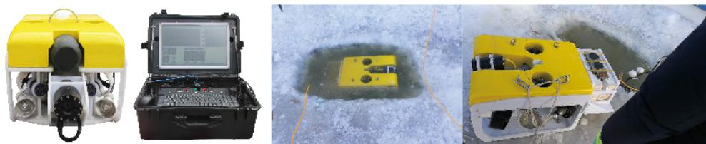
观察级水下机器人 (Spindrift-300 ROV)
