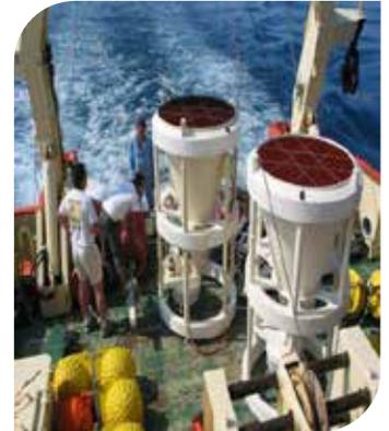
法国 Technicap 公司 沉积物捕获器
