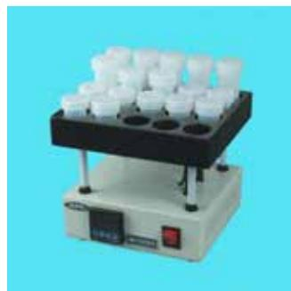
**消解罐：**也称：溶样罐、闷罐、压力溶弹、密闭压力罐等。用来消解难溶地质、地矿样品，广泛应用于地质元素分析行业
