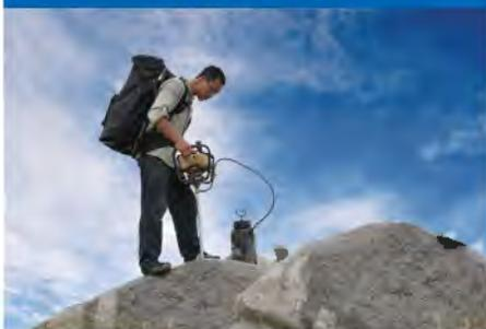
背包式取样钻机是一种适用于崇山峻岭、交通不便缺乏水资源和地区而精心设计的小型轻便化取样钻孔设备。可代替传统的槽探井，物化探异常验证。大量减少对植被的破坏，是**区域地质填图、物化探取样、古地磁取样、地质灾害预防**等浅层地质勘查工作中不可缺少的技术手段。
